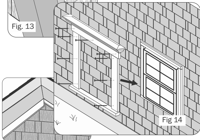
Sistema de sujeción oculta Cortex
